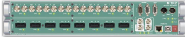
手順:フロントパネルの[RESET] (リセット) ボタンを5秒ほど押さえます。ボタンを押すと最初は素早く点滅しますが、出荷時の設定に復旧できたら、点滅は止まります。
