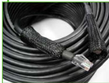
MOGAMI 社製の試作品。プラグ部にカバーをつけてフィールドワーク時の破損を防ぐ工夫をしている。直径 9mm、100m で 8.2Kg でした。AVIOM 社の A-Net Pro 64 では双方向 64ch をこのケーブル 1 本で 150m 伝送可能！！
