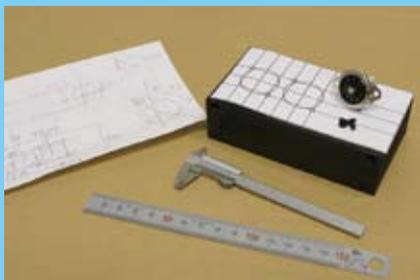
まずはケースの穴あけの準備から。各パーツの寸法を測り、取り付け位置を決定する。CADを使って型紙を作って貼り付けると作業がカンタンだ。ケースはタカチのHEN110306Bを使用した。
