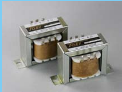
0.7Wの小型トランスでは、どうも歪みっぽい。特注を考えていたところ、運良く2Wの既製品を発見。歪みだけでなく低域の質感などが一気にグレードアップ。
