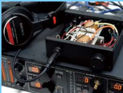
度重なる試聴を行い、良い音となるように回路の定数を決定する。パッシブ回路では、些細な回路の違いが大きな変化となって表れるので設計は難解だ。
