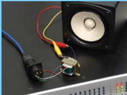
600Ω:8Ωのトランス(600円)を使ってライン音声をスピーカに接続。音量は小さめだが、小型スピーカと組み合わせれば回線チェックなどで活用できそうだ。
