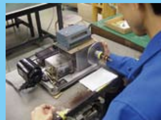
トランス巻線作業の様子
