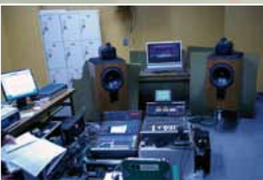
中継室にセットされたメイン収録システム。ProToolsHDで収録された。ステレオミックスはホール外に駐車された中継車に送られた。
