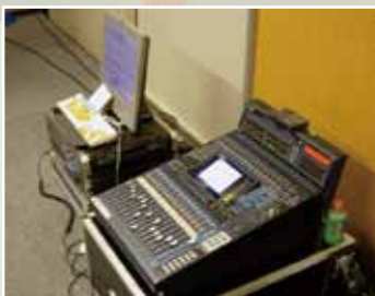
モバイルProToolsの操作部およびモニタリングに使用したYAMAHA/DM1000デジタルコンソール。
