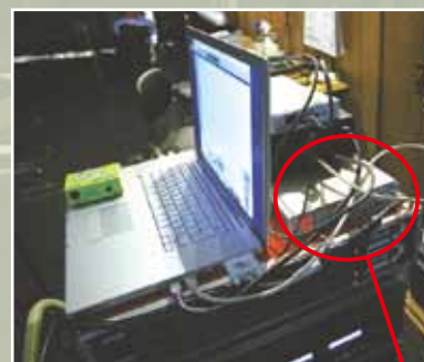
モバイルProTools。左側：ProTools用Mac Book Pro & Millennia HV-3R用MIDI I/F。右側：Magma 1slot シャーシー & HDD
