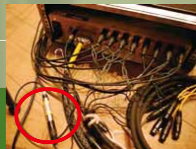
AES シンクはトランスで 75Ω に変換
