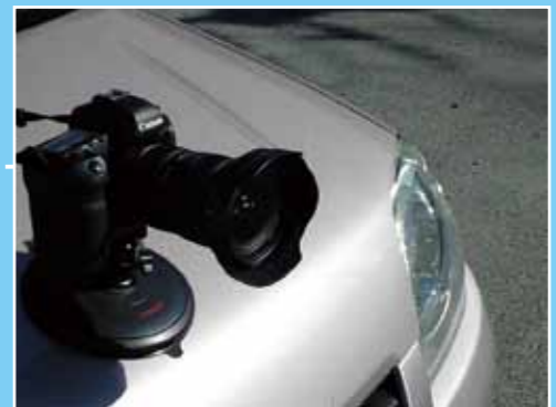
HD動画が撮影可能なデジタル一眼レフカメラをボンネットに取付けるアダプタを製作。テスト撮影でカメラが落下することはなかった。
